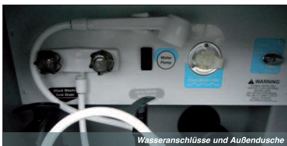
Wasseranschlüsse und Außendusche
